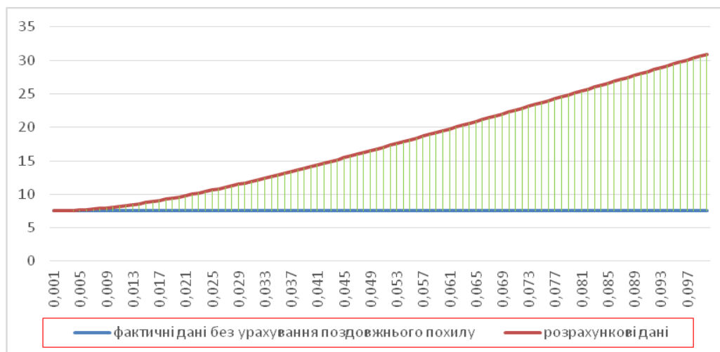
Рисунок 8 – Зміна розрахункової ширини автомобільної дороги від поздовжнього похилу
