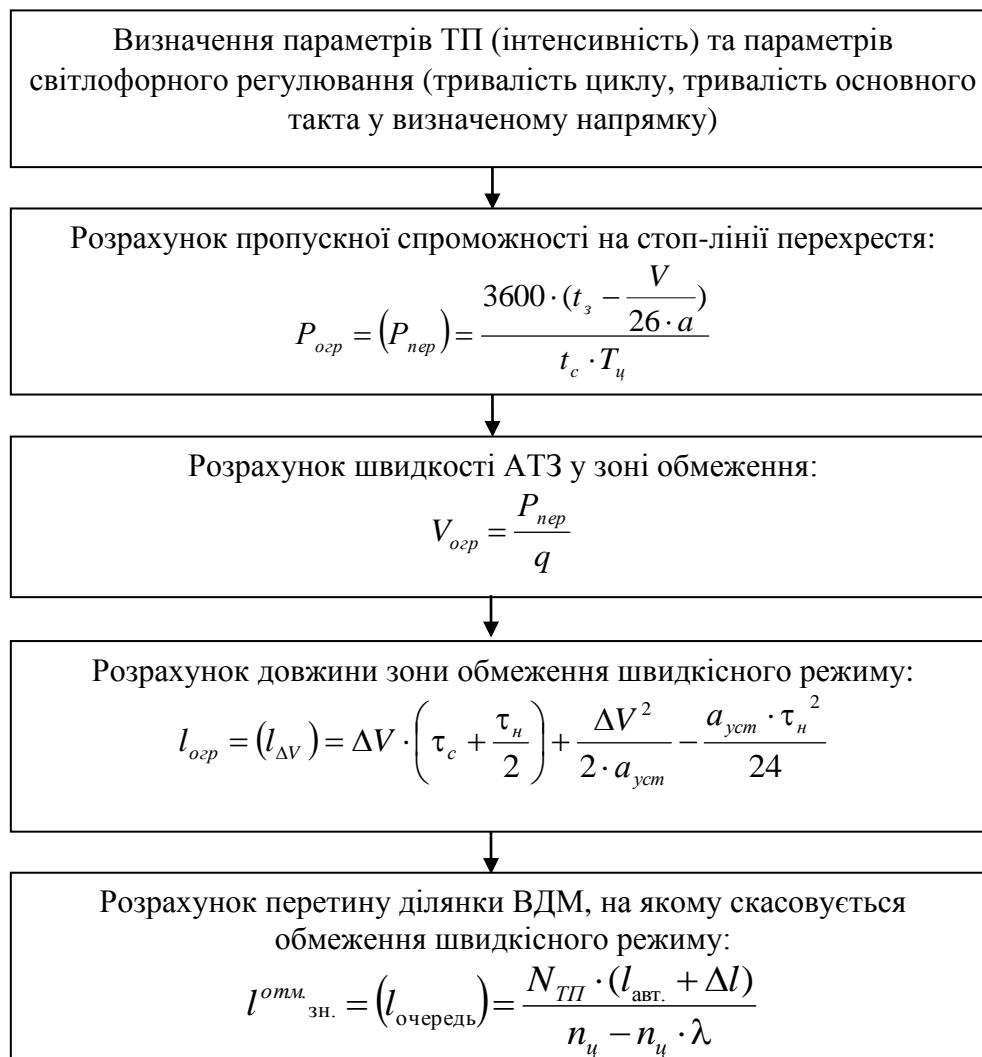
Рисунок 3 – Алгоритм визначення параметрів зміни швидкісного режиму на підході до зони затору
