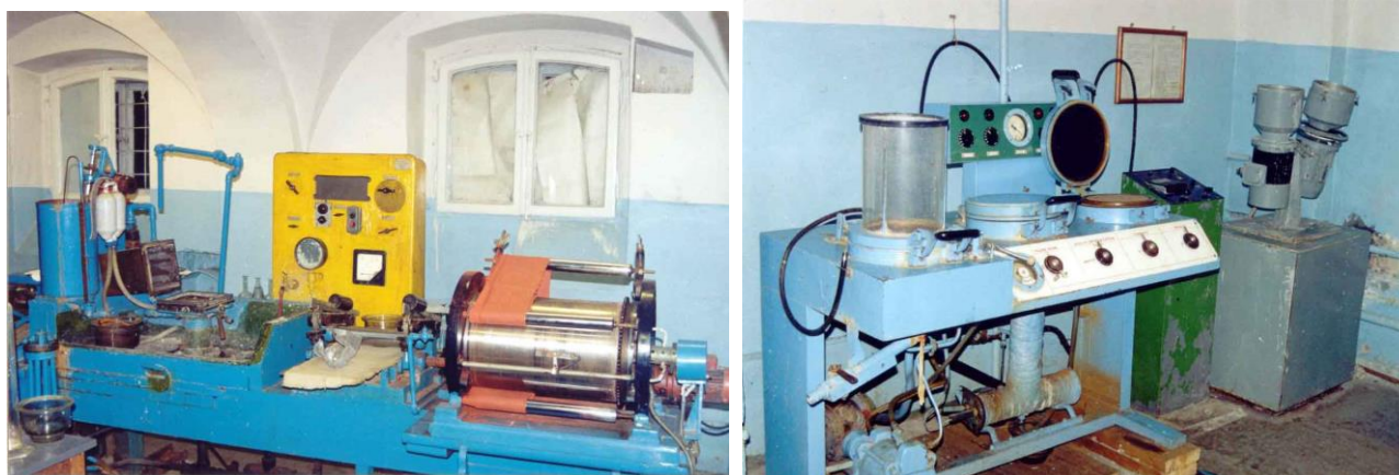
Рисунок 1. Комплект обладнання з диспергатором, млинами, що розмелюють, використовуваного для отримання досвідчених партій паперу, захищених фуллеренами або нанотрубками.
