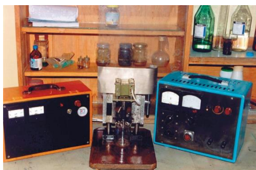
Рисунок 2. Установка для плазмохімічного синтезу наноструктур та Me-вуглецевих композитів у рідкій фазі.
