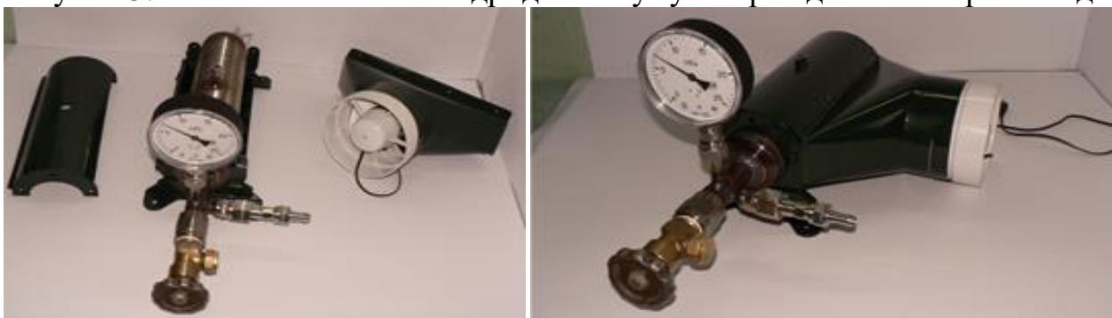
Рисунок 6. Накопичувач (акумулятор) ПВА-275 із внутрішнім нагрівальним елементом.
