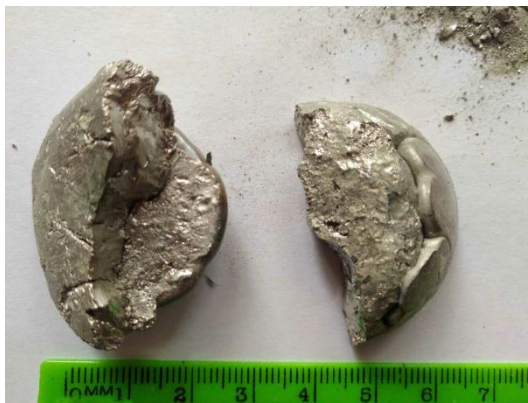
Рис. 3. Сплав носія гідриду водню, який виплавляється у вигляді злитків
