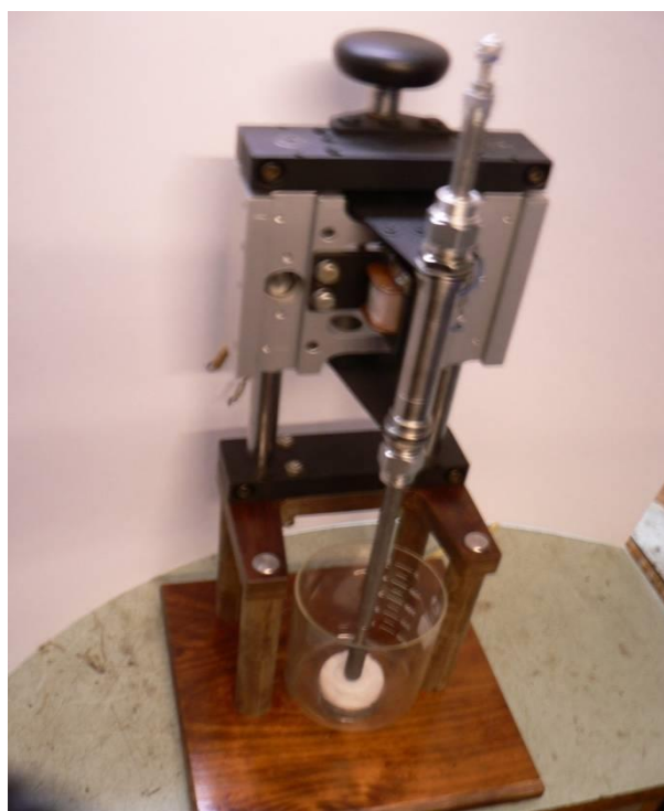
Рисунок 1. Плазмохімічна установка для синтезу наноструктур та нанокompatитів у рідкій фазі з магнітним вібратором.
