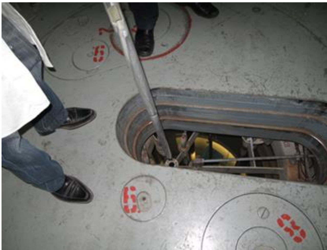
Рисунок 2. Завантаження пеналу із зразками за допомогою механічної штанги у дослідний реактор.
