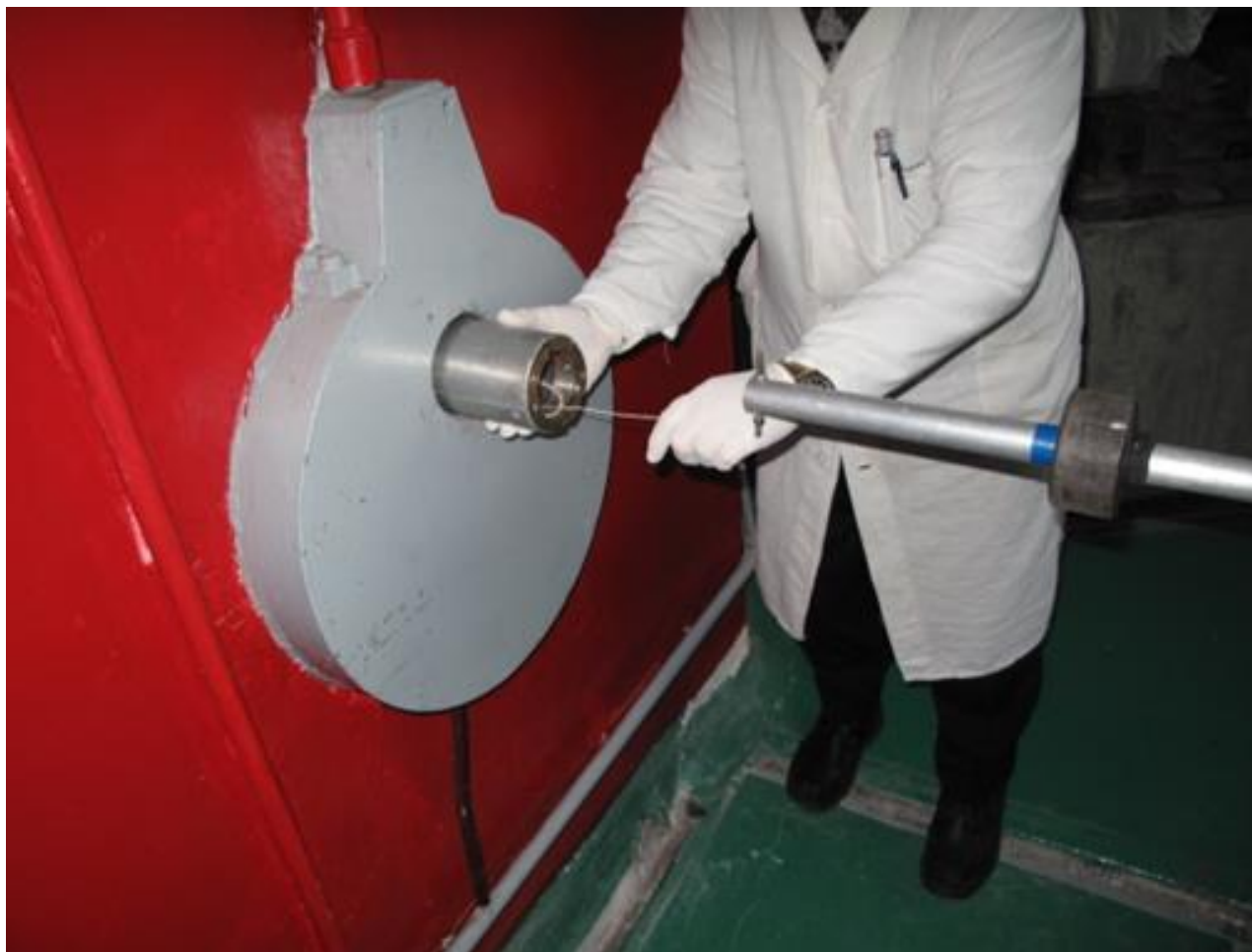
Рисунок 3. Завантаження опромінюваних зразків у ГЕК-3 та роботи з набору флюенса.
