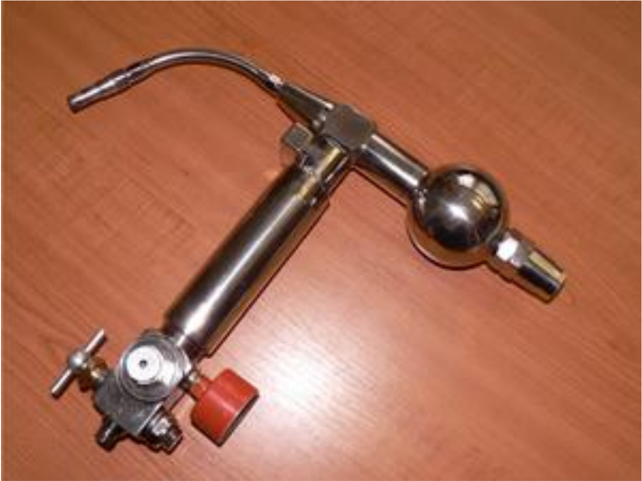
Рисунок 5. Воднево-кисневий пальник з металогідридним акумулятором водню, балоном високого тиску для кисню та п'єзоелектричним підпалом факела.
