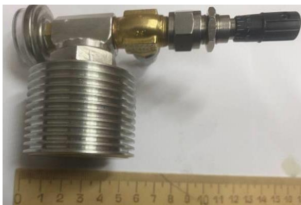
Рисунок 1. Пристрій зберігання водню виготовлено із Al – Mg сплаву.
