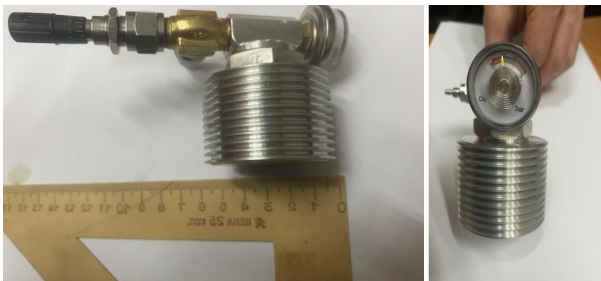
Рисунок 1. Пристрій зберігання водню, виготовлений з дюралюмінію, що робить балон надлегким.
