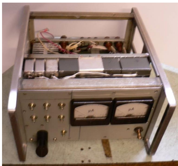
Рисунок 2. Блок живлення плазмохімічної установки для синтезу наноструктур та нанокомпозитів у рідкій фазі з магнітним вібратором.
