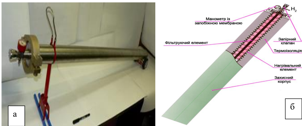
Рисунок 3. Лабораторний металогідридний накопичувач-компресор Sveztag високочистої водню, призначений для роботи в лабораторних умовах. а - зовнішній вигляд; б - схема накопичувача-компресора.
