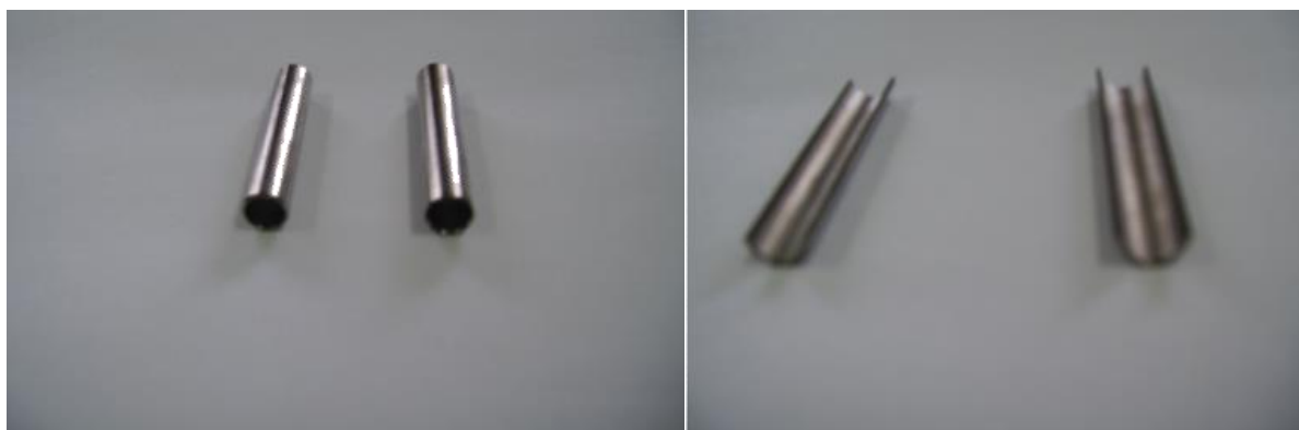
Рисунок 1. Зразки оболонок чохла твелів ядерних реакторів КТЦ-110.
