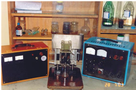
Рисунок 2. Установка для плазмохімічного синтезу наноструктур та Ме-вуглецевих композитів у рідкій фазі.
