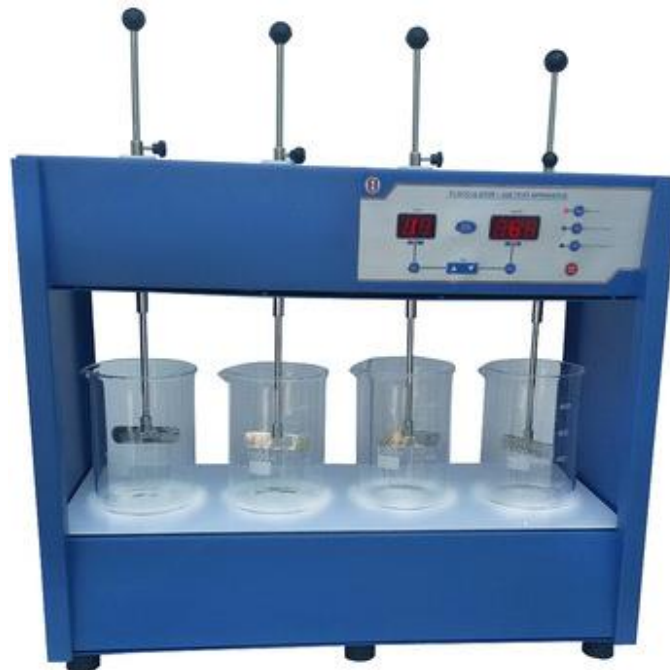
Рисунок 2. Установка Jar Test для проведения коагуляционных испытаний
