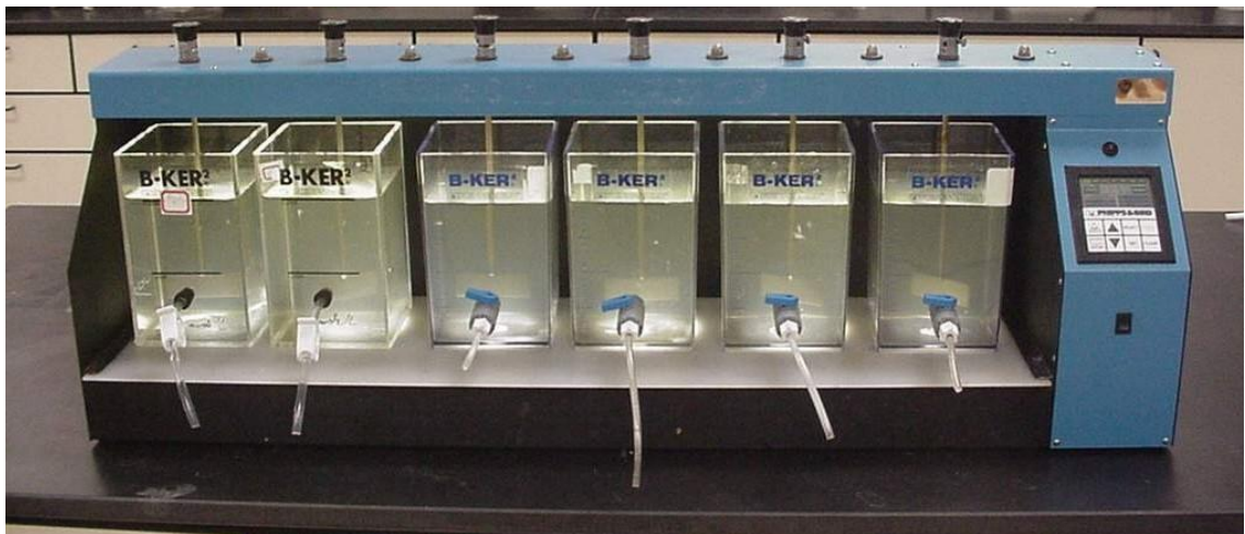
Рисунок 1. Установка пробного коагулирования «Капля»
