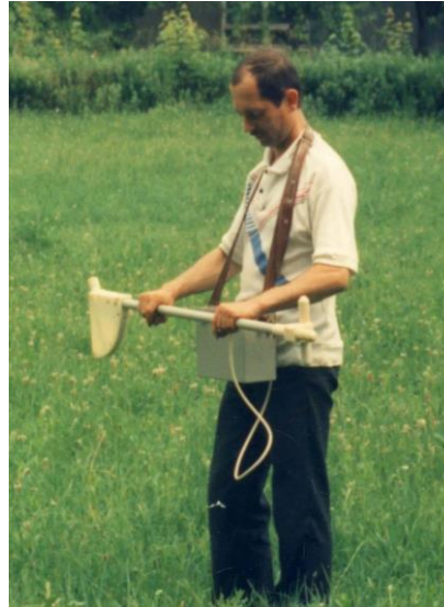
Рис. 1. Робота з апаратурою БІТ-КВП (з азимутальною орієнтацією бази) під час обстежень підземного трубопроводу.
