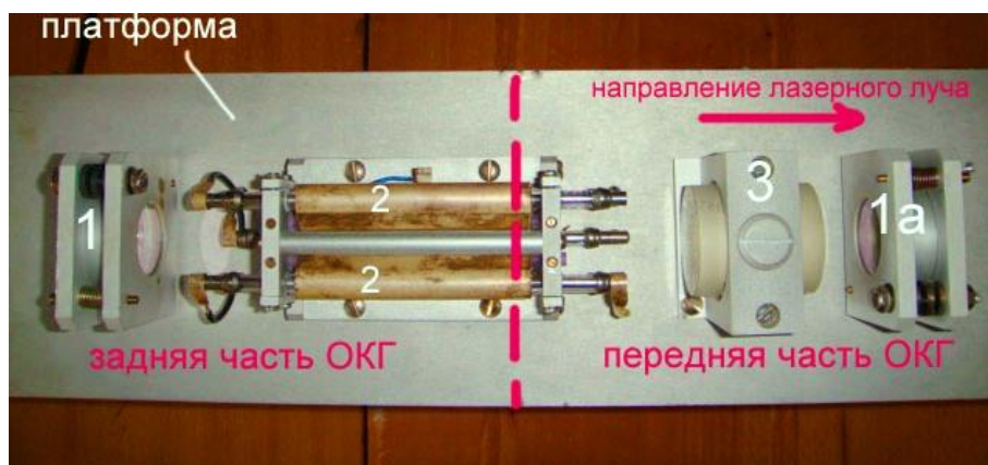
Рисунок. 2. Оптичний блок (вигляд зверху): 1 и 1а – плоскі дзеркала резонатора з коефіцієнтами відбивання 99 і 39% відповідно; 2 - імпульсна ксенонова лампа накачування; 3 - кювета з барвником, що прояснюється; 4 - платформа.
