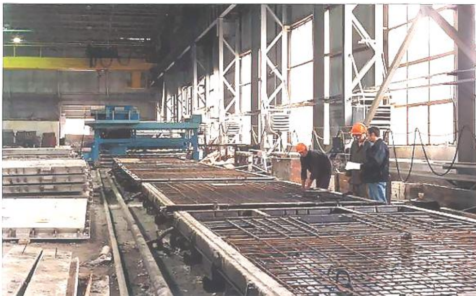
Рис.4. Цех по випуску залізобетонних виробів , елементів каркасу будинку.
