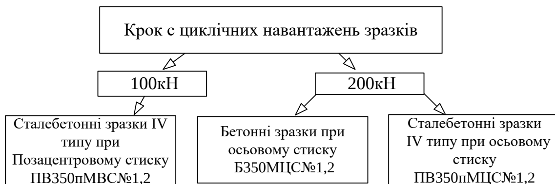
Рисунок 11. Схема передачі циклічного навантаження при випробуваннях
