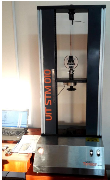
Figure 9. Universal tensile machine UIT STM 010.
