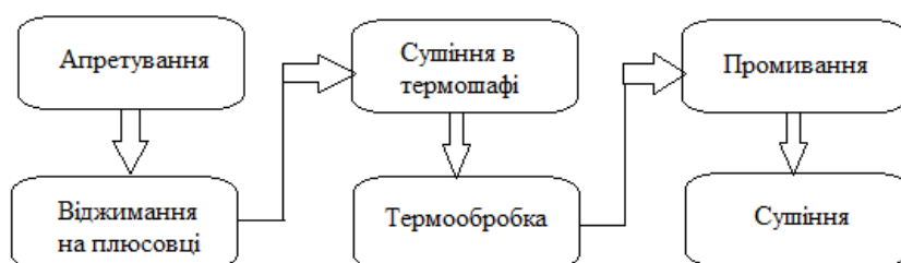
Рисунок 3. Технологічна схема антимікробної обробки бавовняної тканини композицією на основі наночастинок міді та заліза [410].
