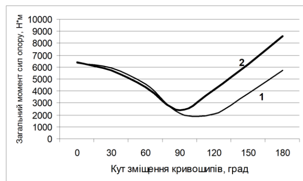
Рисунок 7. Графіки зміни відхилень зведеного моменту сил опору \Delta M_{on \max} (1) та \Delta M_{on} (2) в залежності від кута зміщення кривошипів
