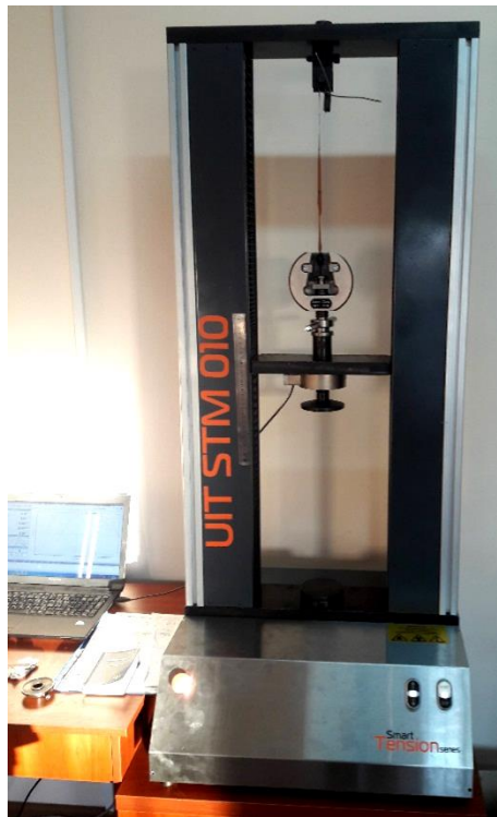
Figure 9. Universal tensile machine UIT STM 010.
