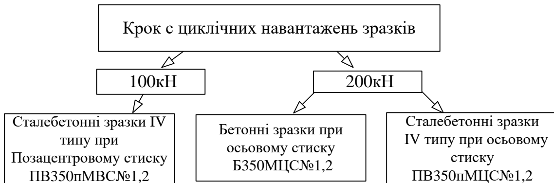
Рисунок 11. Схема передачі циклічного навантаження при випробуваннях
