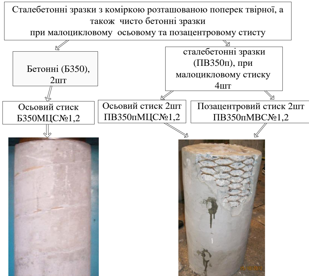
Рисунок 8. Структурна схема та послідовність проведення серії експериментальних досліджень
