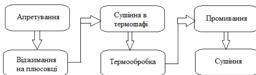
Рисунок 3. Технологічна схема антимікробної обробки бавовняної тканини композицією на основі наночастинок міді та заліза [410].
