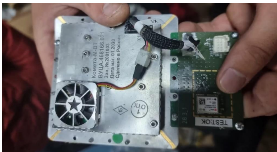
Рис. 9 Зовнішній вигляд блоку “КОМЕТА”, що був демонтований з БПЛА оперативного-тактичного рівня “Орлан-10”.
