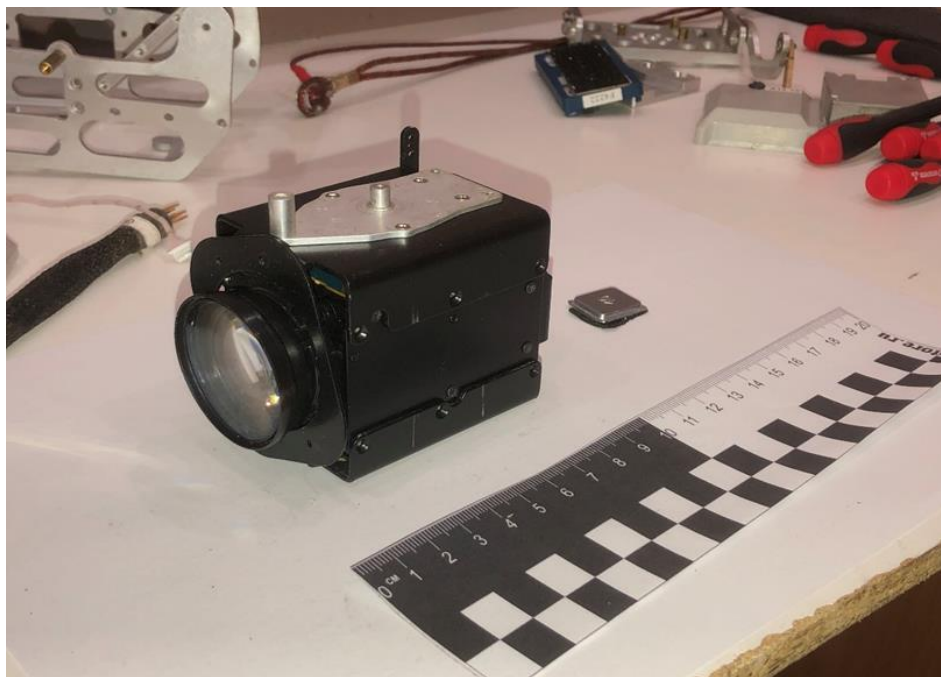
Рис. 2 Варіант використання камери видимого спектрального діапазону SONY FCB-EV7520
