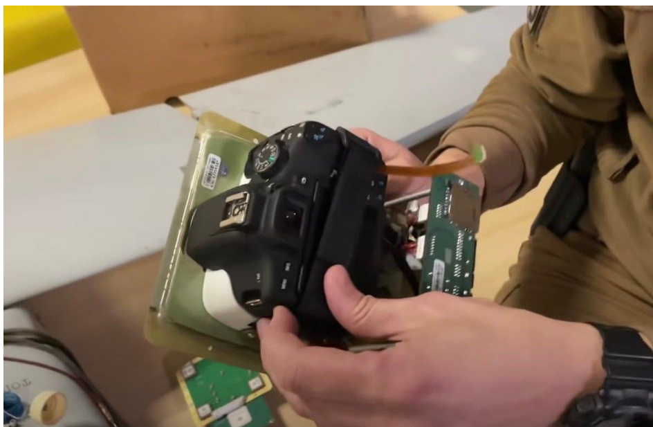
Рис. 3 Варіант використання фотоапарату CANON в якості камери видимого спектрального діапазону
