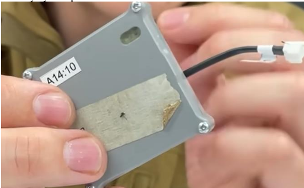
Рис. 10 Зовнішній вигляд GPS-трекеру з підтримкою SIM – карти БпЛА оперативно-тактичного рівня “Орлан-10”
