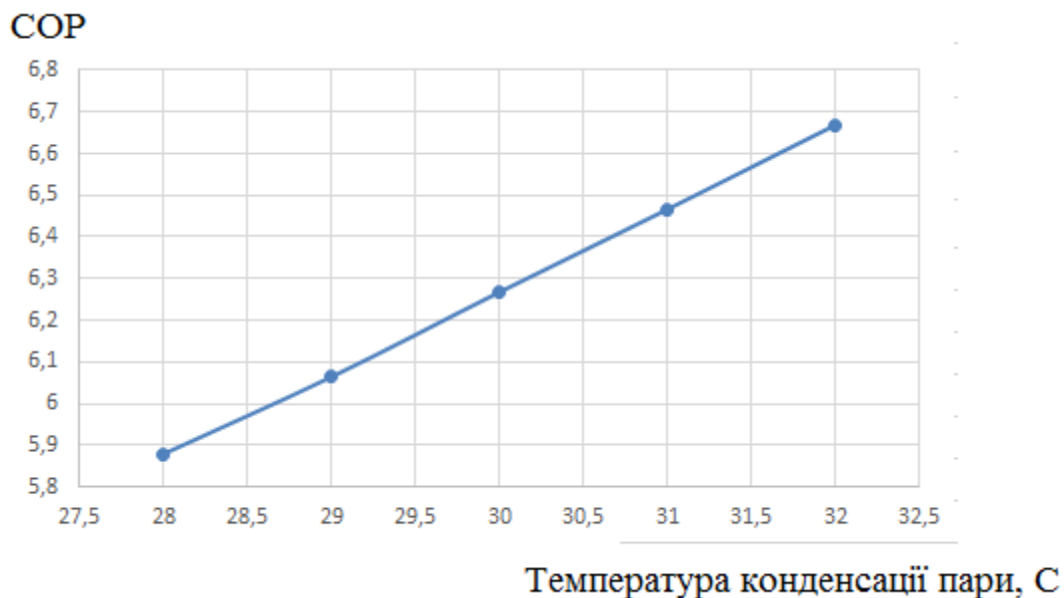
Рисунок 2. Залежність COP від температури конденсації пари в конденсаторі турбоустановки (температура мережевої води 55 С)
