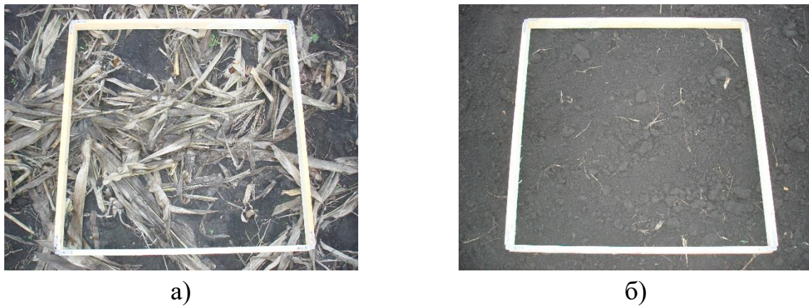
а) б) Рис. 1. Рослинні залишки кукурудзи на дослідних ділянках площею 1 м 2 до (а) та після (б) проходження експериментальної установки подрібнювача
