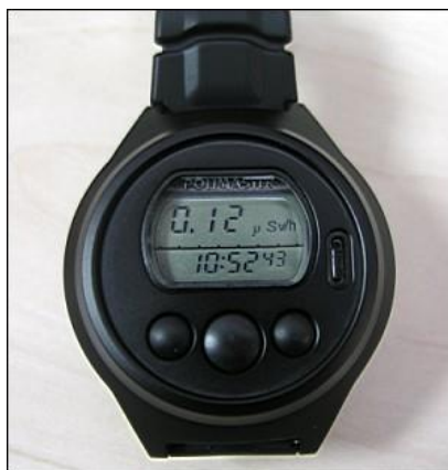
Рис.6. Радіометр наручний "ДКГ-PM1603A" (індивідуальний)
