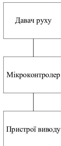
Рисунок 1- Структурна схема збору аналогової інформації
