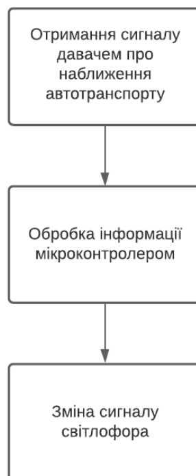
Рисунок 2 – Основні етапи роботи автоматизованого управління світлофором
