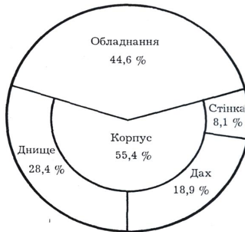
Рисунок 1. Діаграми частоти відмов елементів конструкції резервуара (%) внаслідок корозійних пошкоджень
