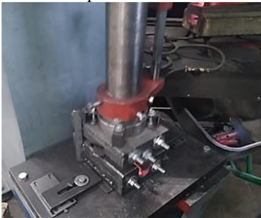
Рисунок 3. Гаряче штампування на пресі
