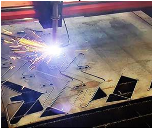
Рисунок 1. ЧПУ плазмове різання
