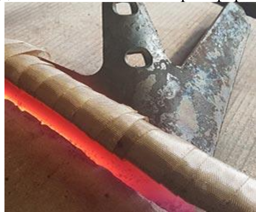
Рисунок 4. Загартування ТВЧ з електронним керуванням
