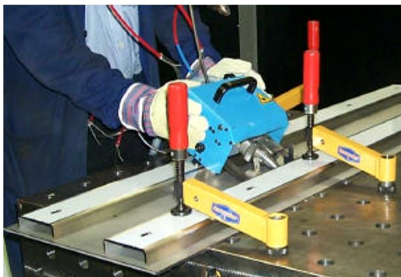
Малюнок 6. Лазерне зварювання просторових конструкцій за допомогою ручного лазерного інструмента LHSG-2 [272].
