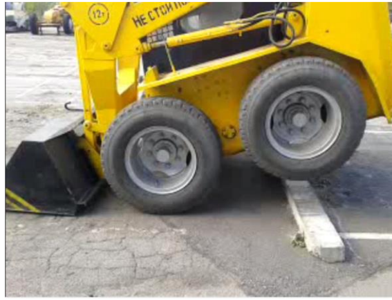
Рисунок 1. Відрив задніх коліс під час подолання навантажувачем одиначної перешкоди
