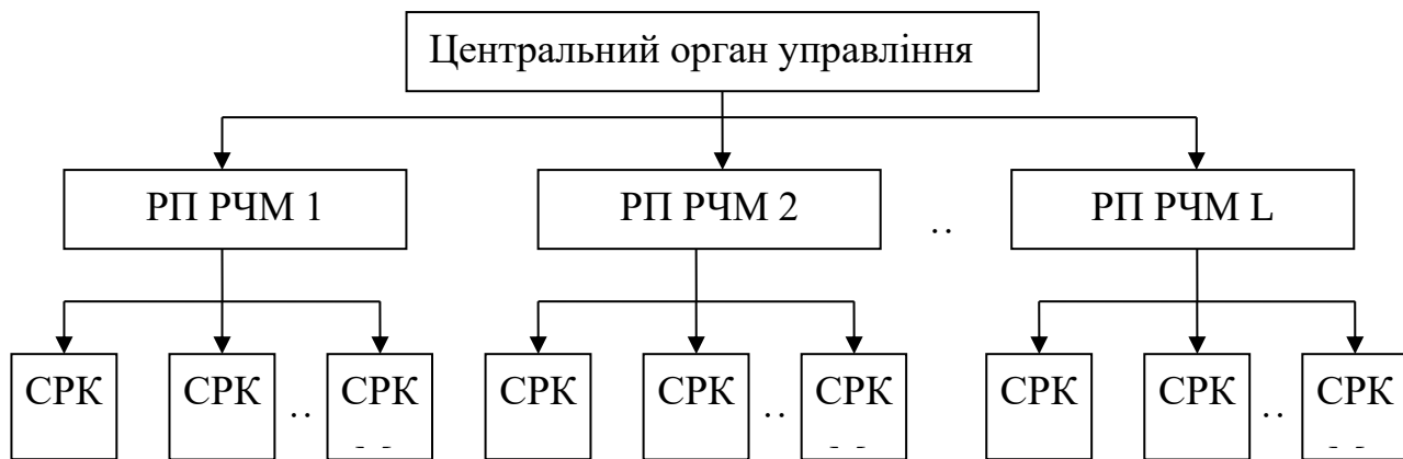
Малюнок 1. Узагальнена організаційна структура системи радіочастотного моніторингу
