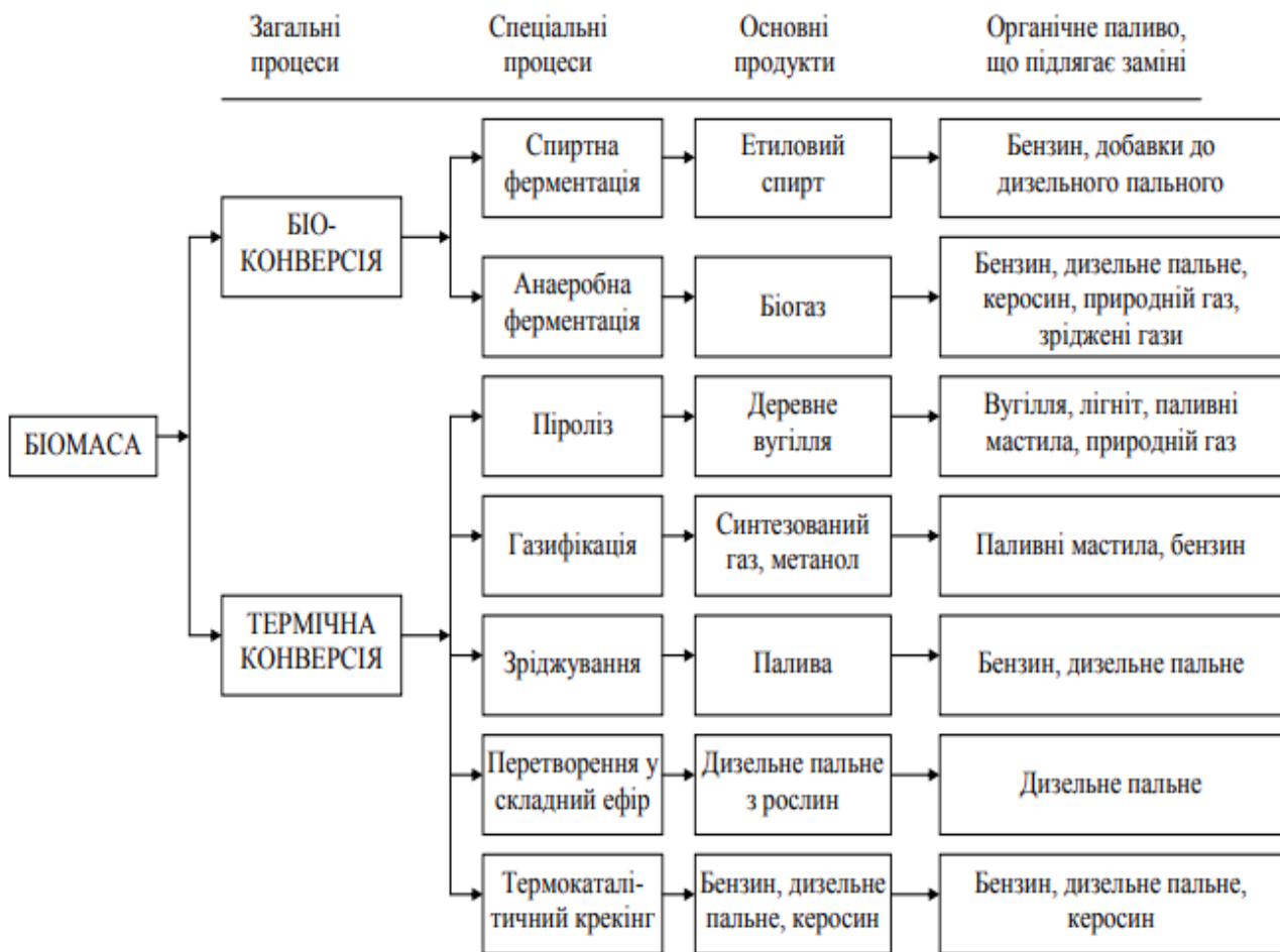
Рис.1. Класифікація технологій із процесом поетапного перетворення біомаси в енергетичний продукт
