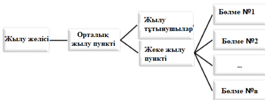
2 сурет – Ғимараттың жылумен жабдықтау жүйесінің жылу моделінің құрылымы
