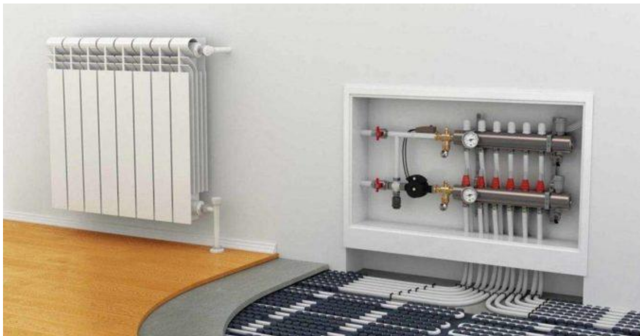
Рис 1 – Комбінована система радіаторного опалення та теплої підлоги
