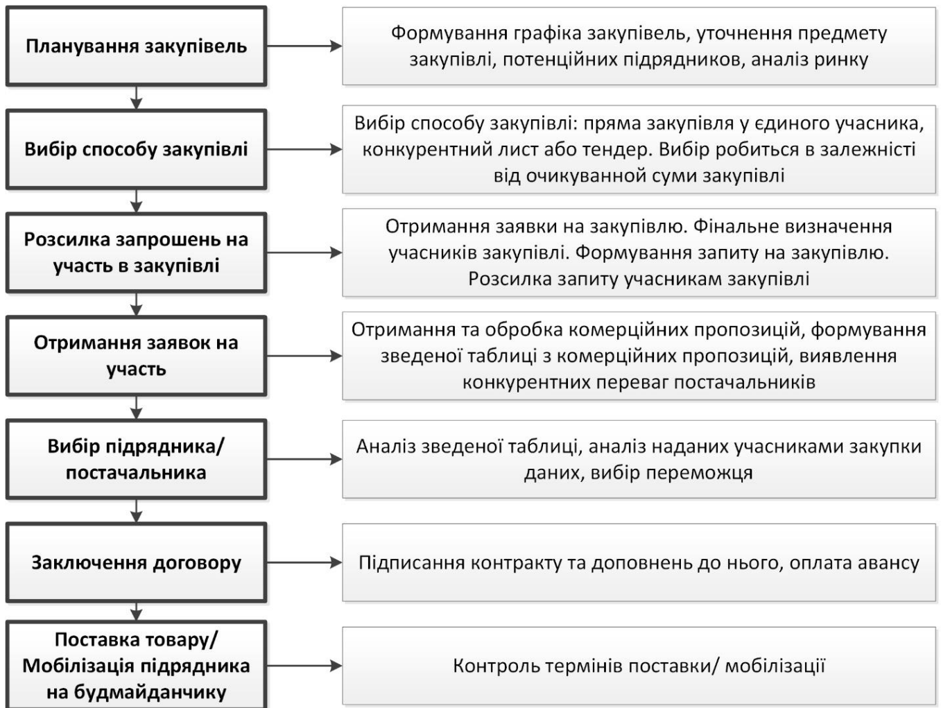
Рис. 1. Процес закупівель у будівництві
