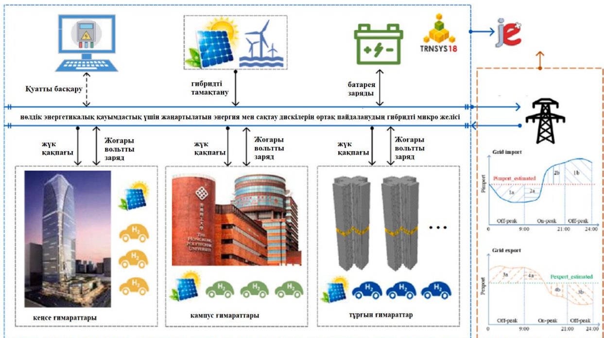
Сурет 5. Нөлдiк энергетикалық қауымдастық үшін пайдаланылатын гибриді жаңартылатын энергия және сақтау жүйесінің құрылымы.
