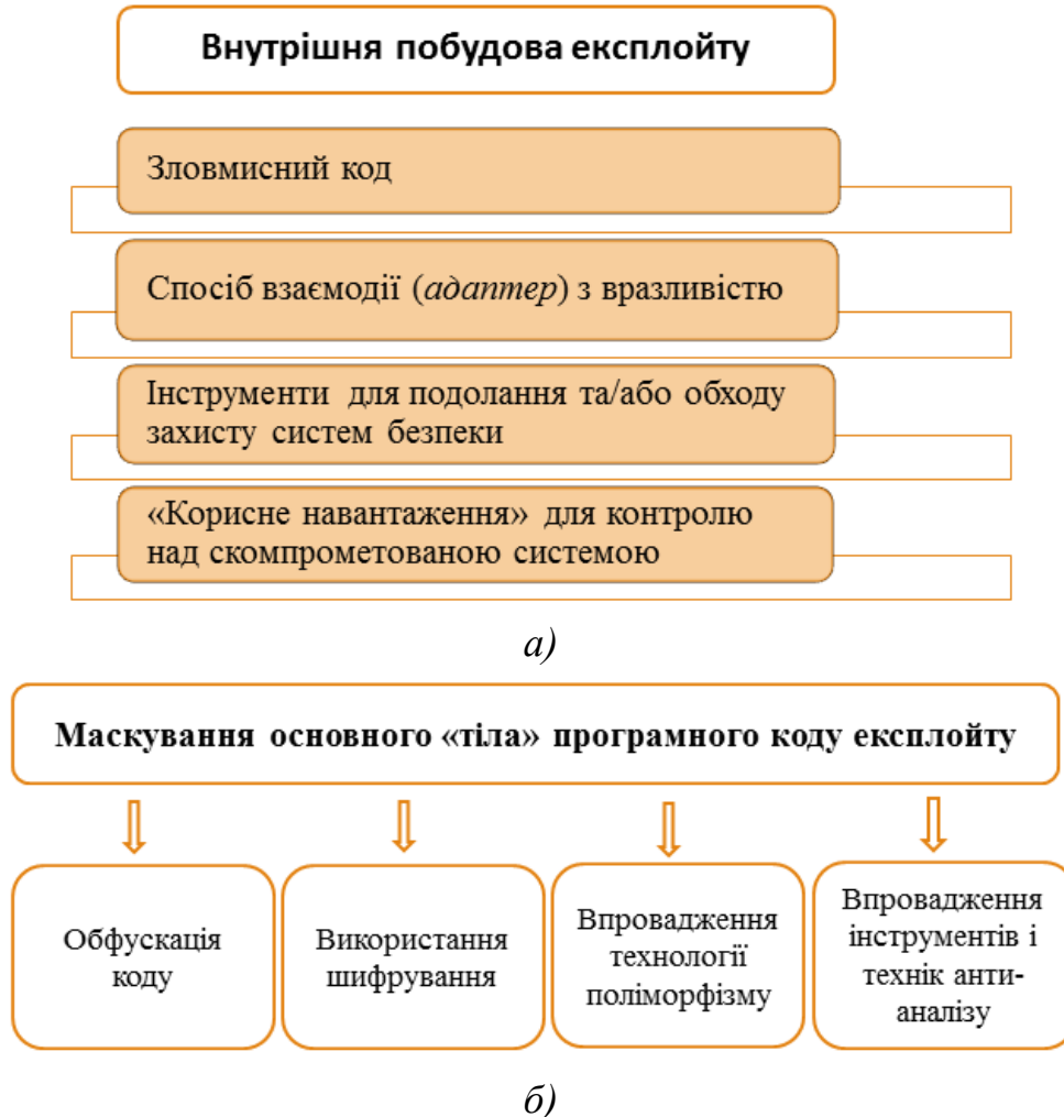
Рис. 2. Внутрішня структура (а) та способи маскування (б) програмного коду експлойтів
