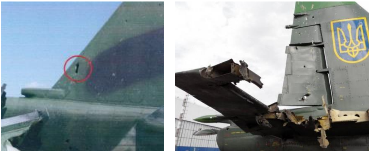
Рис. 4. Одиночне та множинні бойові пошкодження кіля та стабілізатора літака типу Су-25
