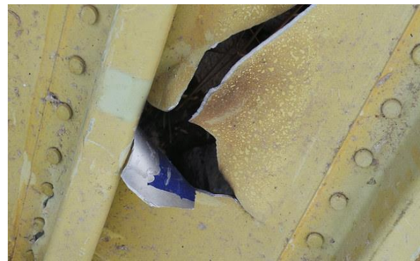
Рис. 8. Пробиття обшивки крила з руйнуванням полки лонжерона
