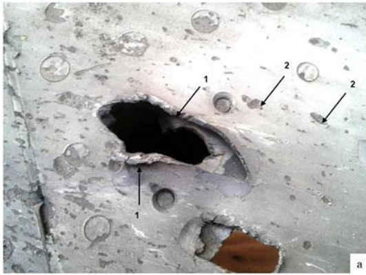
Рис. 5. Наскрізна пробоїна обшивки крила від босприпасу калібру 30 мм
