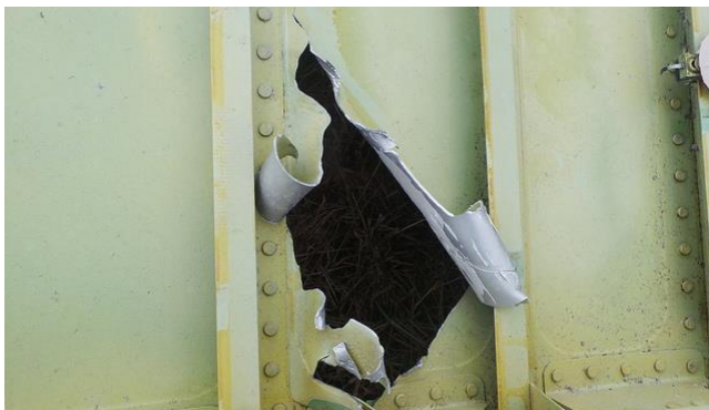
Рис. 7. Руйнування обшивки крила з руйнуванням стрингера
