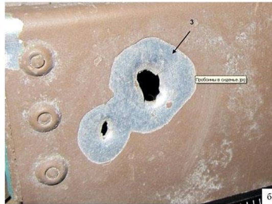
Рис. 6. Наскрізні пробоїни фюзеляжу від уламків босприпасу калібру 23 мм
