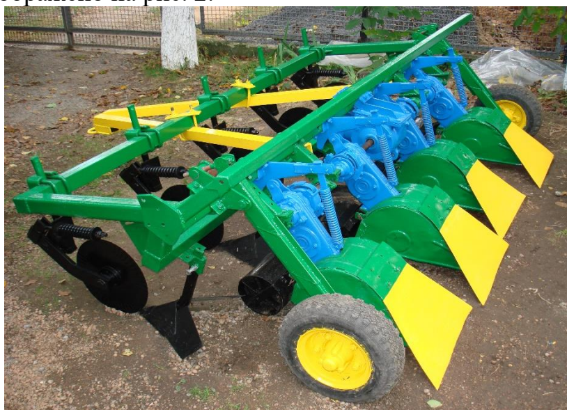
Рис. 2. Дослідний зразок подрібнювача рослинних залишків гребостеблових культур КФП – 2,8
