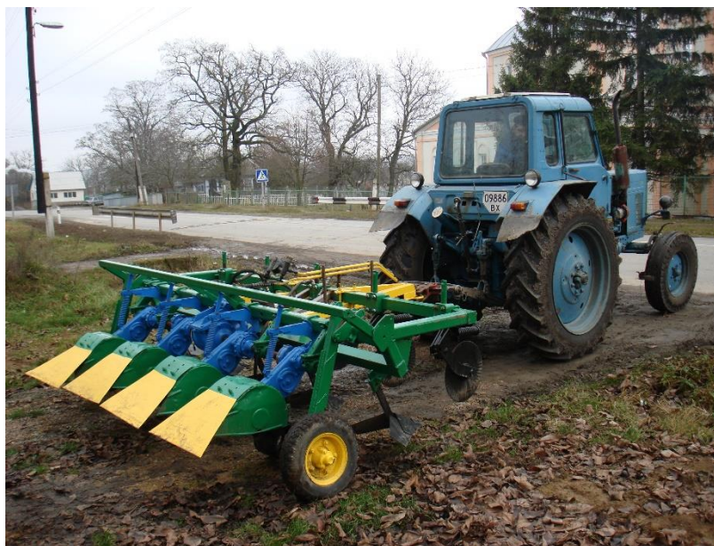
Рис. 3. Подрібнювач КФП – 2,8 в транспортному положенні
