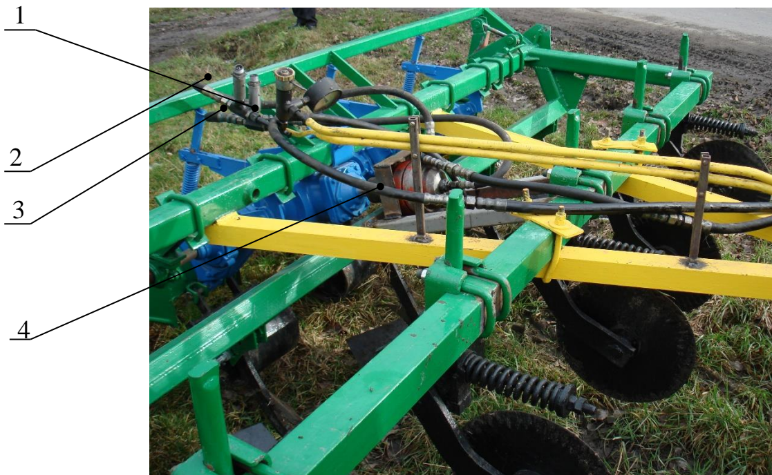
Рис. 1. Елементи гідроприводу подрібнювача
