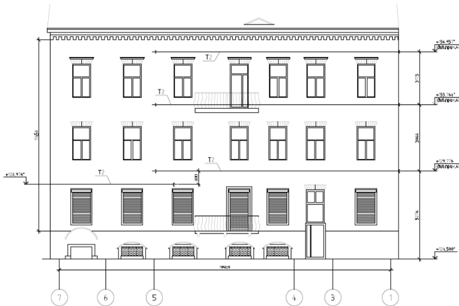
Рисунок 2. Загальний схема підсилення будівлі тяжами
