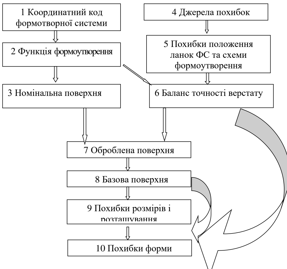
Рис. 1.5 Структура моделі вихідної точності верстата
