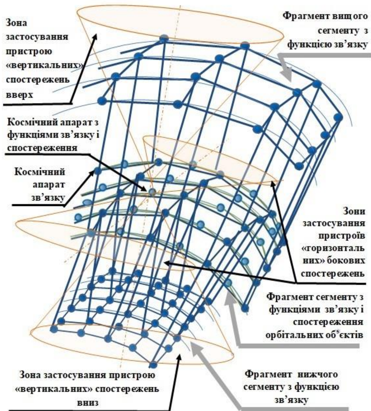
Рисунок 1 – Фрагменти сегментів супутникової мережі: два фрагменти з функцією зв'язку і один фрагмент з функціями зв'язку і спостереження орбітальних об'єктів
