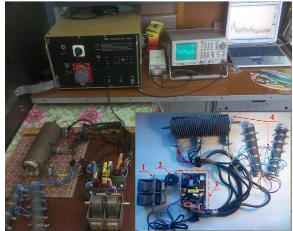
Рис.5.5. Підготовчий стэнд для вимірювань ЕМЗ генерованим перетворювачем напруги.
