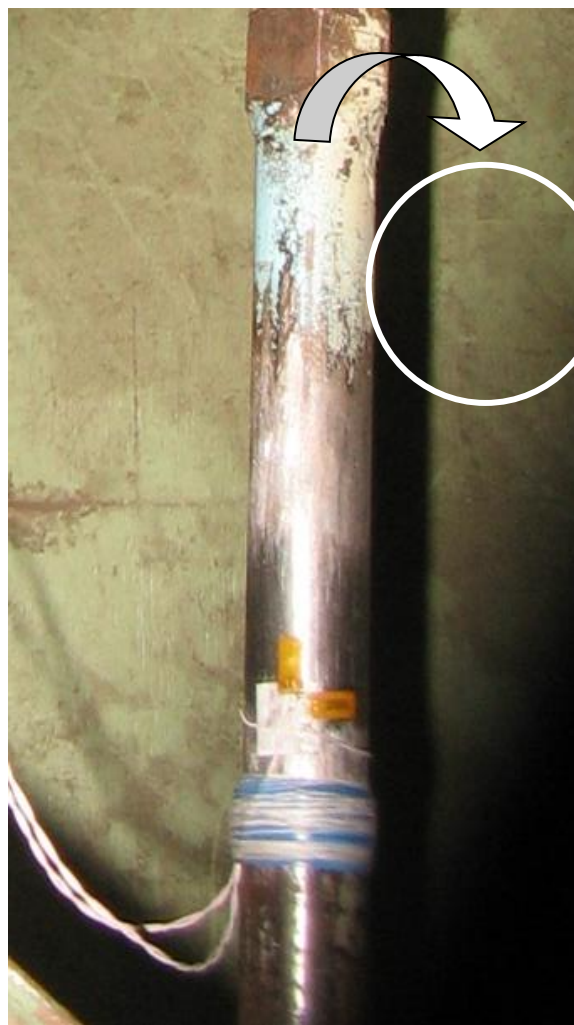
Рисунок 4. Розташування тензодатчиків на шатуні
