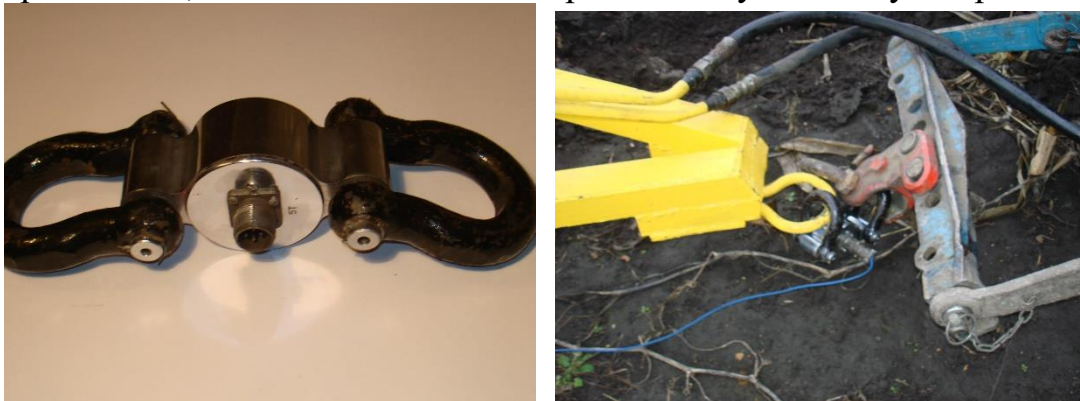
Рис. 4. Обладнання для вимірювання тягового опору експериментальної польової установки подрібнювача
