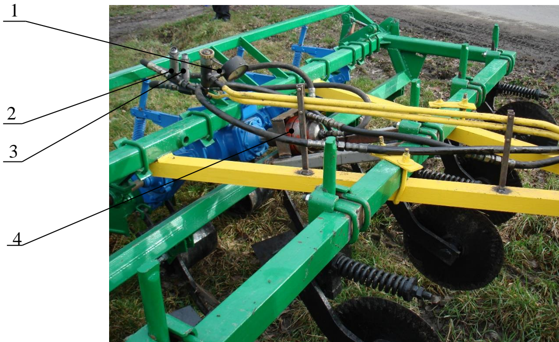
Рис. 1. Елементи гідроприводу подрібнювача
