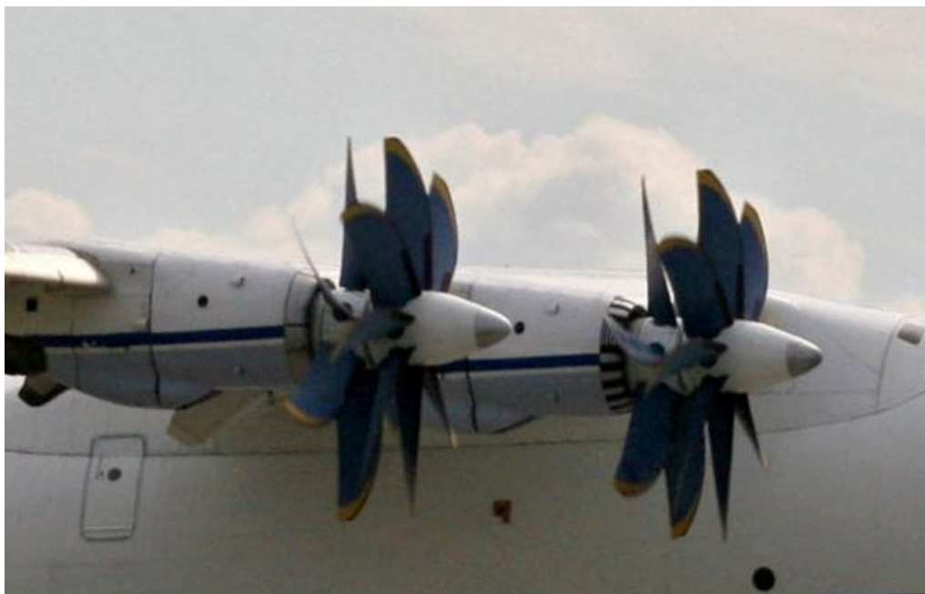
Рис. 1.1 – двигун Д-70 (створений за схемою open rotor) літака АН-70
