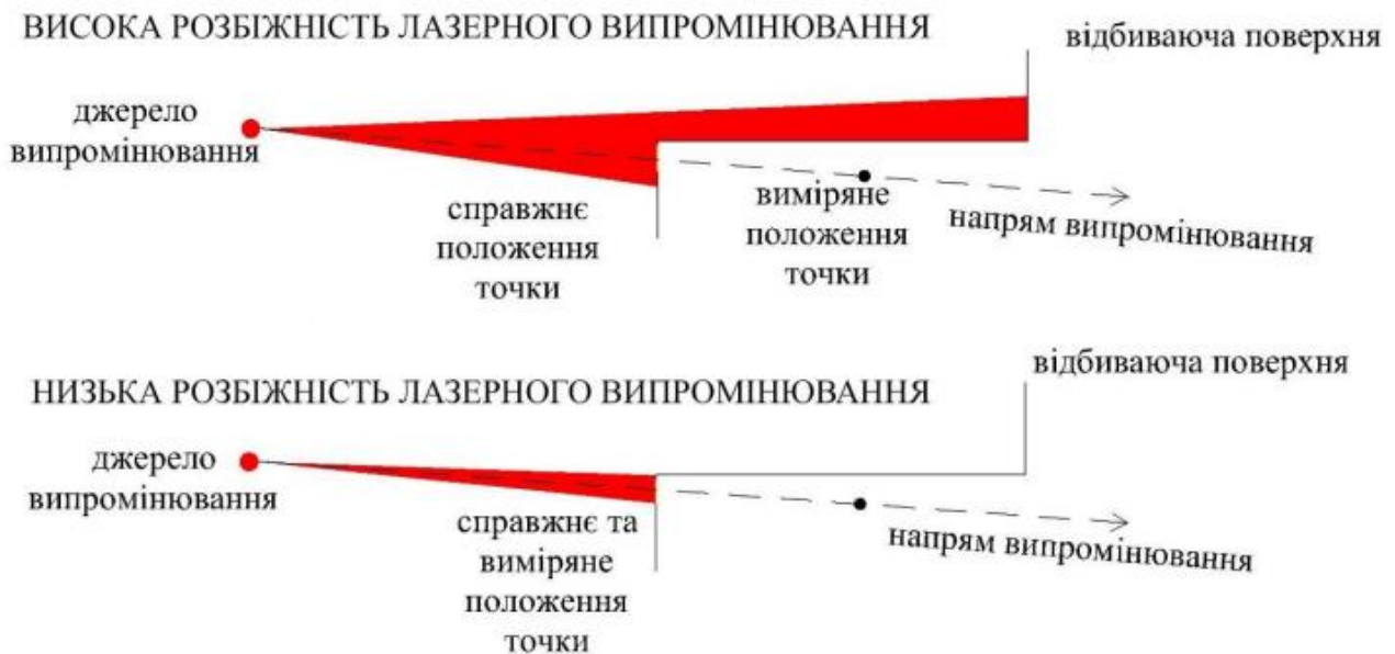
Рисунок 5. Помилки у вимірюванні відстаней, викликані високою розбіжністю лазерного випромінювання [259]
