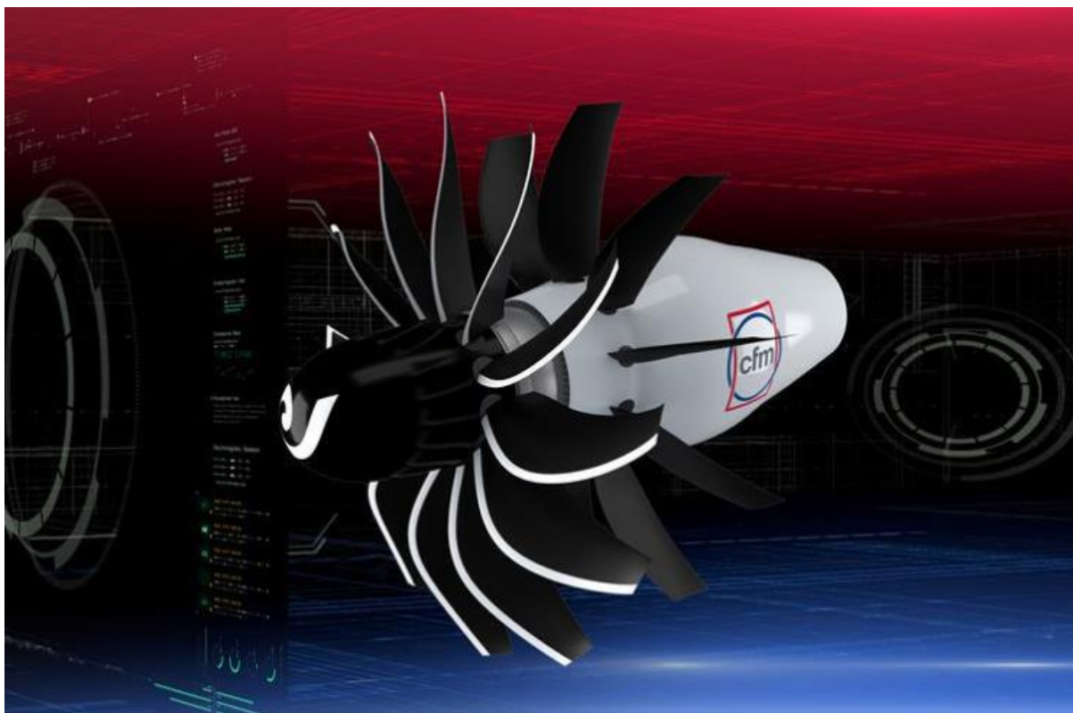
Рис. 1.2 – концепт двигуна RISE з відкритою роторною архітектурою [78]
