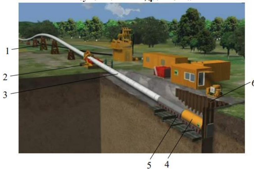
1 – роликова опора; 2 – гідроштовхач; 3 – трубопровід; 4 – прохідний щит; 5 – направляюча рама; 6 – укріплювальний щит
