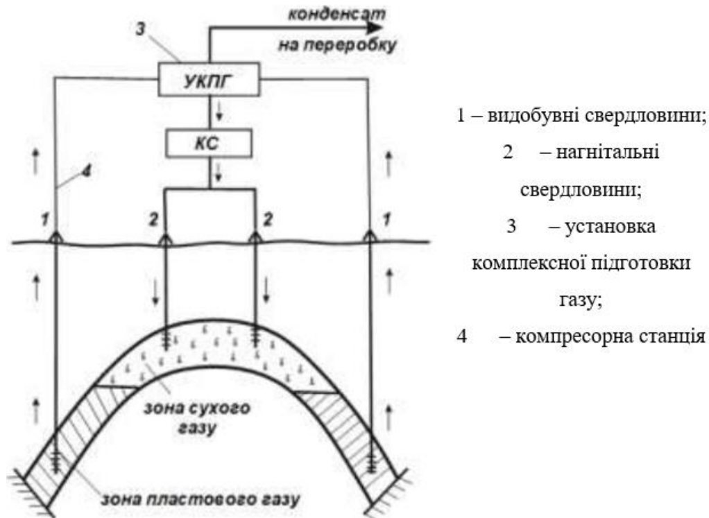
Рисунок 1. Принципова схема підтримування пластового тиску у газоконденсатному родовищі зворотним нагнітанням сухого газу у пласт
