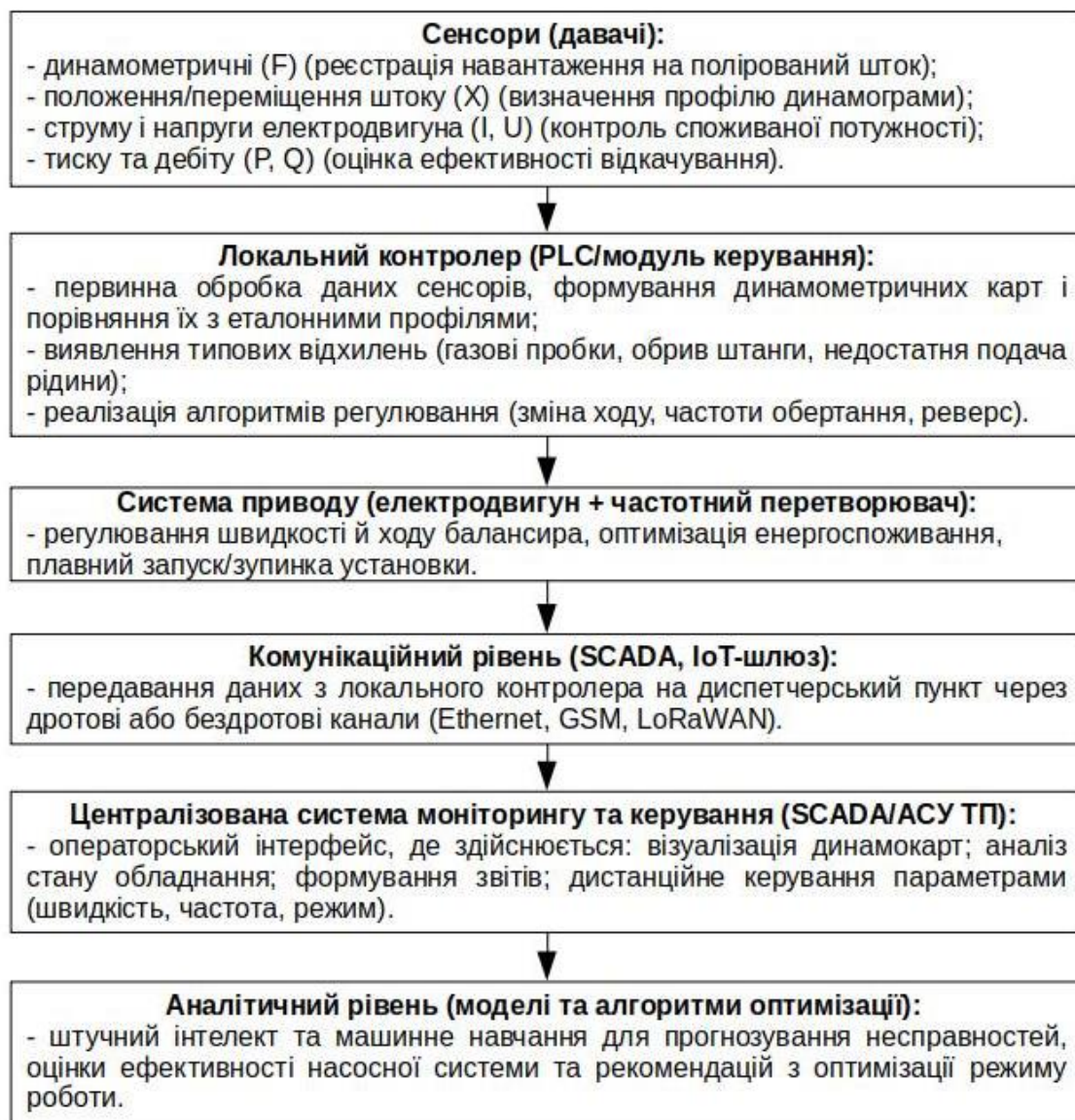
Рисунок 1. Узагальнена структура системи керування ШГНУ.
