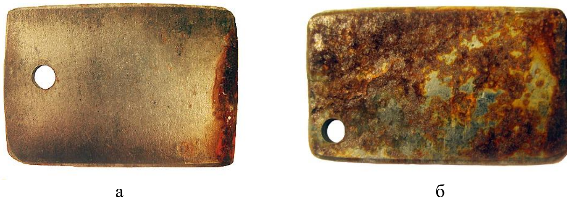
Рисунок 3. Корозійні ушкодження на зразках із дослідної сталі 03X8CЮ [1]
