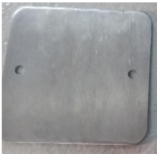
Рис. 3. Приклад стану поверхні після додаткового повстяного полірування [Фото Несін В.В.]
