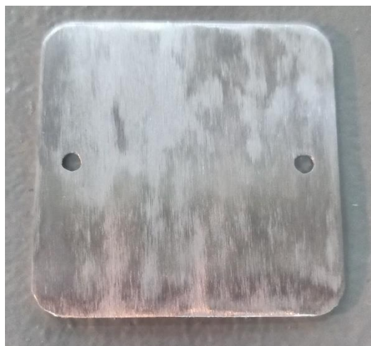
Рис. 2. Стан поверхні після основної операції шліфування [Фото Несін В.В.]
