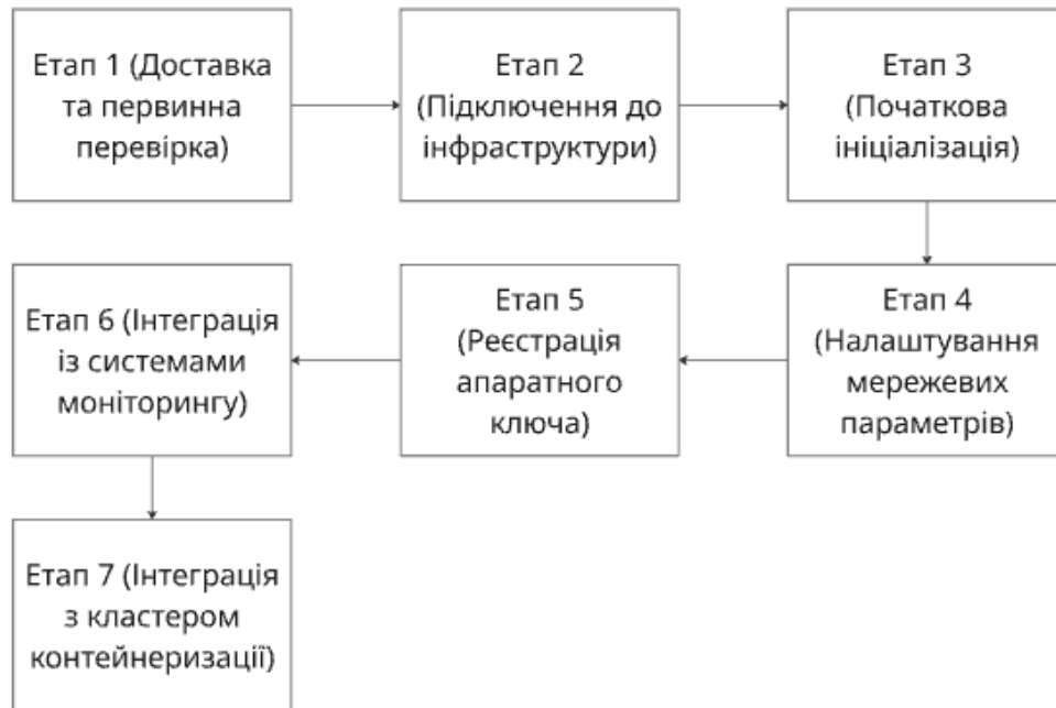
Рисунок 14. Етапи методу підключення до апаратного ключа в кластерному середовищі [авторська розробка]
