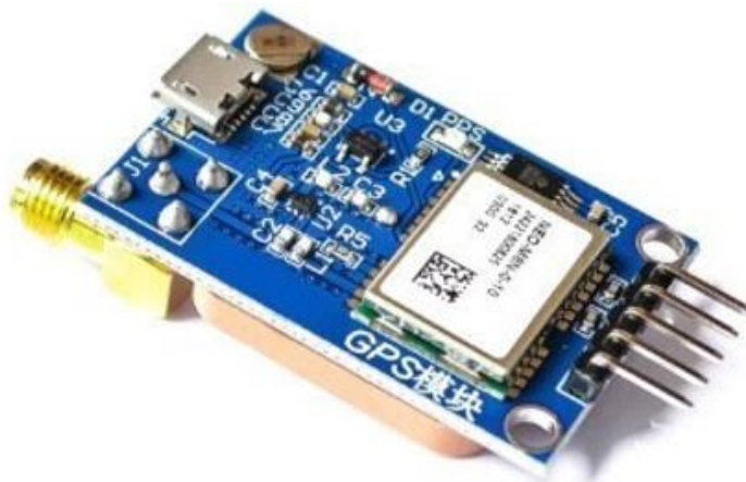
Рисунок 9. GPS модуль NEO-8M [129]
