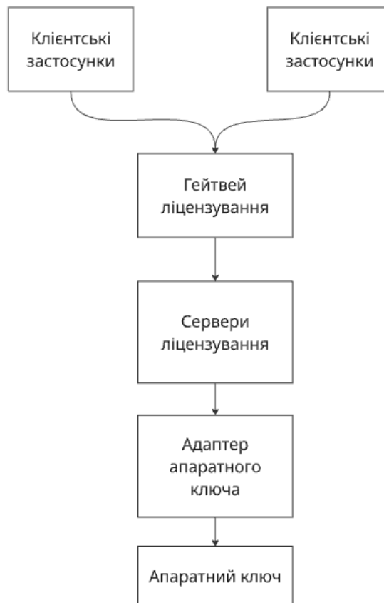
Рисунок 12. Програмна модель доступу до апаратного ключа [авторська розробка]
