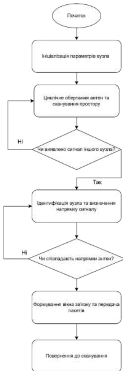
Рисунок 1. Блок-схема роботи прототипу алгоритму Джерело рисунка: розробка автора.
