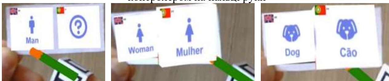
(б) приклад візуалізації зображень для двох мов на ArUco-маркерах та контролера на Barcode-маркері
