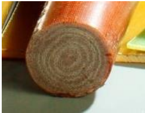
Рис. 2. Приклад перерізу «класичної» спіральної форми текстолітового стрижня Джерело рисунка: [1].
