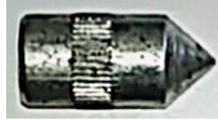
Малюнок 5. Захисний елемент, який був вилучений з каналу ствола пістолета без значного зусилля.
