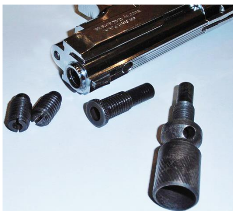
Малюнок 3. Захисні елементи та мортирка пістолета ZORAKI мод. 914-S. Розробка автора.
