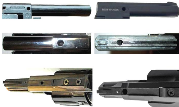
Малюнок 2. Варіанти розташування газовідвідних отворів на стволах стартових пістолетів і револьверів.
